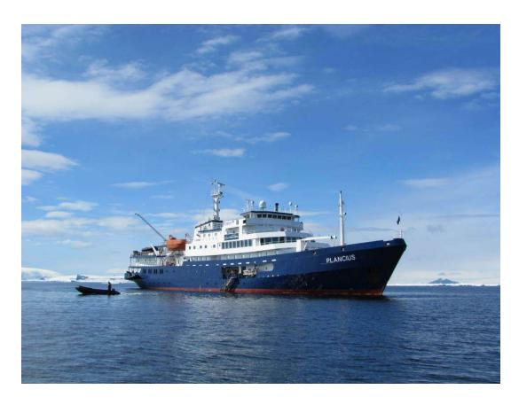
普兰修斯号是以一位著名的荷兰天文学家,地理学家,地质学家,帕托斯.普兰修斯(1552-1622)的名字命名。普兰修斯号建于1976年,作为海洋探索科考船在荷兰皇家海军服役,直到2004年Oceanwide探险公司将其收购并在2007年完成重新改建,变成了可以搭载114名乘客的探险船。普兰修斯号长89米,14.5米宽,最大吃水5米,1D级抗冰,最高时速12+节,搭载3台1230马力柴油发动机。
