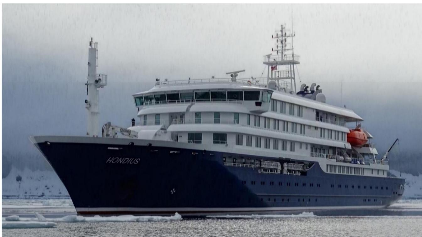
宏迪斯号于2019年在克罗地亚建造，是Oceanwide探险公司的探险船。宏迪斯号长107.6米，宽17.6米，最大吃水5.3米，拥有非常高的抗冰等级PC6级，最高时速15节，搭载2台高马力柴油发动机。宏迪斯号可搭载176名乘客，拥有83间客房。美丽而又现代化的宏迪斯号可以携带369立方米淡水，并且水泵房每天可以制造70立方米淡水。从各方面来说，宏迪斯号都是在极地进行探险最完美的船只！
