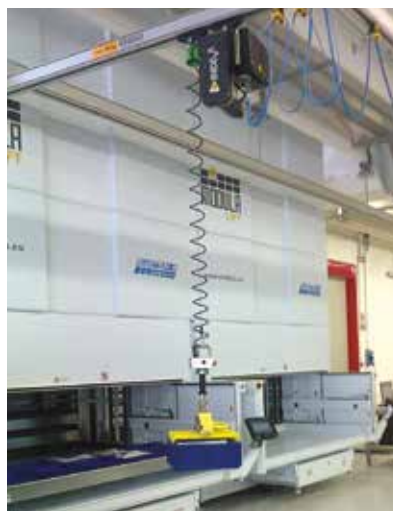
Poignées sensibles déportées sur tête, avec contre poids pour centre de gravité.
