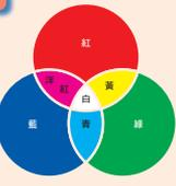
3. 透明物體的顏色：白光照射至透明物體時，由能穿透的色光，決定透明物呈現的顏色。
