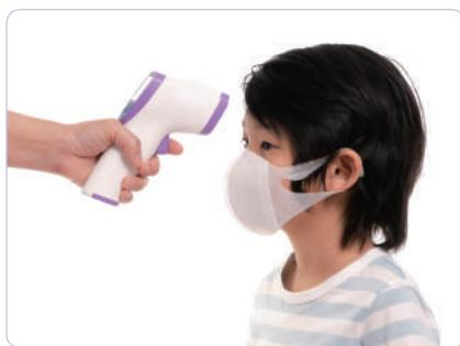
圖 3-33 紅外線溫度計可用於測量額溫
