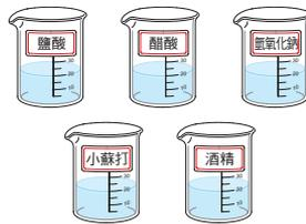
6 取未經過檢測導電性的蒸餾水與上述的水溶液，逐次利用玻棒沾取，滴在紅色與藍色石蕊試紙上，檢測其酸鹼性。
