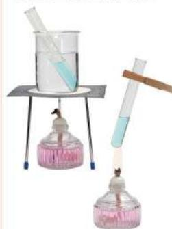
① 加熱試管時，應以試管夾夾住管口上方1/3處，使試管略微傾斜從底部加熱，輕移試管使受熱均勻，管口切勿對準人。
