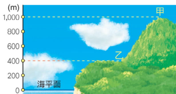
圖 1-3-22 海拔高度與相對高度示意圖
