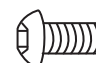
10. Screws M6 x 20 mm (4) Vis M6 x 20 mm (4) Tornillo M6 x 20 mm (4)
