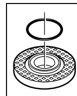
**针对 M 14 主轴的固定法兰：**在固定法兰 10 的定心轴环上有一个塑料零件 (O 形环)。如果缺少 O 形环或 O 形环损坏了，务必在继续使用之前更换固定法兰 10。
