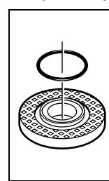
**Bích lắp cho trực máy mài có cỡ M 14:** Chi tiết bằng nhựa (vòng đệm chữ O) được lắp vào vành định tâm của bích lắp **10**. Nếu vòng đệm chữ O bị mất hay bị hư, phải thay bích lắp **10** trước khi cho máy hoạt động trở lại.
