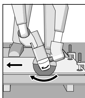
Máy luôn luôn phải được vận hành theo chuyển động mài ở tư thế thẳng đứng. Nếu không như vậy, có sẵn nguy cơ bị đẩy mà không điều khiển được máy ra khỏi mạch cắt.
