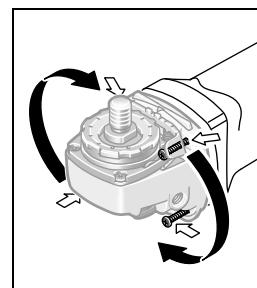
หัวเครื่องสามารถ หมุนได้เป็นชั้น ชั้นละ 90° ในลักษณะนี้ ท่าน สามารถนำลิฟท์บีด- ปิดไปยังตำแหน่งที่ สะดวกต่อการใช้งาน มากกว่าสำหรับสภาพ การทำงานที่เฉพาะ เจาะจง ด. ย. เช่น สำหรับผู้คนมือซ้าย ขันสกรูทั้งสี่ด้านออก จนสุด หมุนหัวเครื่อง ไปยังตำแหน่งใหม่อย่างรวดเร็ว โดยไม่ต้องออกจาก ตัวถัง ขันสกรูทั้งสี่ด้านเข้าไปและยืดให้แน่น
