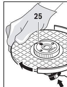
Tekan tombol penahan poros kerja **1** untuk menahan poros kerja. Untuk mengencangkan mur untuk poros kerja yang dibuka dan dikunci dengan tangan, putarkan mata gerinda dalam arah jalannya jarum jam dengan keras.
