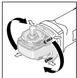
機器操作者可根據需要分段式轉動機頭，每一段的旋轉角度為 90 度。此功能的優點是能夠在特殊的工作狀況下，把起停開關移動到比較容易操作的位置，例如針對左撇子。
