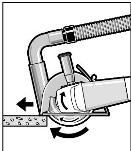
开动电动工具，并把导引装置的前端放置在工件上。参考工件的物料，适当地施力推进机器。
