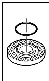
**Flens untuk poros kerja M 14:** Di dalam flens untuk poros kerja **10** di sekitar tingkatannya pemuatan ada satu bagian dari bahan sintetik (ring-O). **Jika ring-O tidak ada atau rusak,** flens untuk poros kerja **10** mutlak harus digantikan, sebelum Anda melanjutkan penggunaan perkakas.
