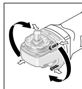
Il est possible de faire pivoter le carter d'engrenage par paliers de 90°. Ceci permet de mettre l'interrupteur Marche/Arrêt dans une position de maniement favorable à des utilisations spécifiques, p. ex. pour les gauchers.
