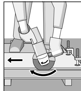
Arah pemotongan harus selalu berlawanan dengan arah gerak dari alat kerja. Jika tidak, ada bahaya perkakas listrik terlompat dengan tiba-tiba dari jalur pemotongan.
