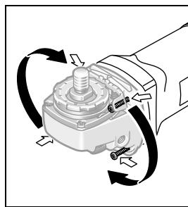
기기의 헤드는 90° 각도로 돌릴 수 있습니다. 이렇게 함으로써 특수한 작업을 할 경우 전원 스위치를 기기 조작이 수월한 위치로 움직일 수 있습니다. 예를 들면 원손잡이 작업자에게 유리합니다. 4 개의 나사를 완전히 풀어 줍니다. 기어의 헤드를 조심스럽게 하우징에서 빼지 않은 상태에서 새로운 위치로 돌립니다. 4 개의 나사를 다시 조입니다.
