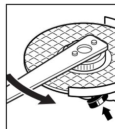
如果安裝正確，而且快速螺母未損壞的話，一般可以用手朝著逆時針的轉向擰松快速螺母。
