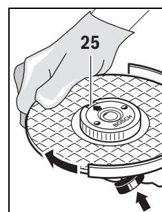
使用主軸鎖定鍵 1 固定主軸。然後朝著順時針的方向用力地轉動砂輪，以便擰緊快速螺母。
