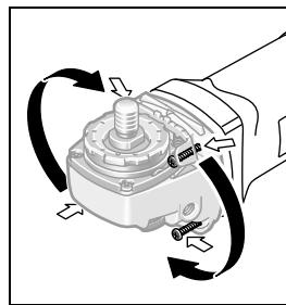
机器操作者可根据需要分段式转动机头，每一段的旋转角度为 90 度。此功能的优点是能够在特殊的工作状况下，把起停开关移动到比较容易操作的位置，例如针对左撇子。
