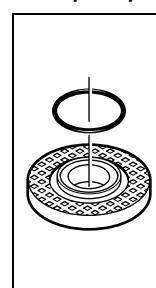
**Flasque de fixation pour broche porte-outil M 14 :** Un joint en plastique (rondelle élastique) est directement monté autour de l'alésage du flasque **10**. Au cas où cette rondelle élastique fasse défaut ou qu'elle soit endommagée, il faut absolument remplacer la flasque d'entraînement **10** avant de continuer à l'utiliser l'outil.
