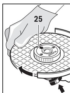
Khóa trực máy mài bằng nút khóa trực máy 1. Để siết chặt đai ốc khóa nhanh, xoay thật chặt dĩa mài theo chiều đồng hồ.
