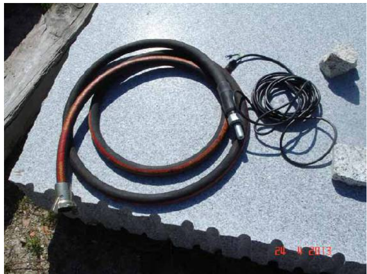
Conexión con boquilla de 4 mm., comando remoto electro neumático en baja tensión de 8 voltios,
