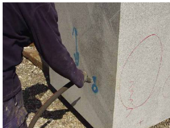
Bloque de granito Blanco Castilla con graffiti de spray con pintura azul Superficie cortada de disco, tipo apomazado, no pulida
