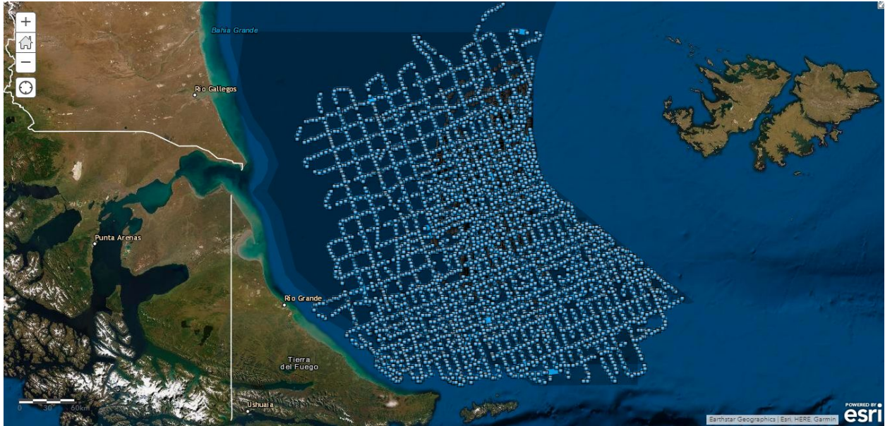
Figura 5: Detalle sísmica Malvinas Oeste y Austral. (Cada punto representa un reporte de posición del barco mientras efectuaba sísmica).
