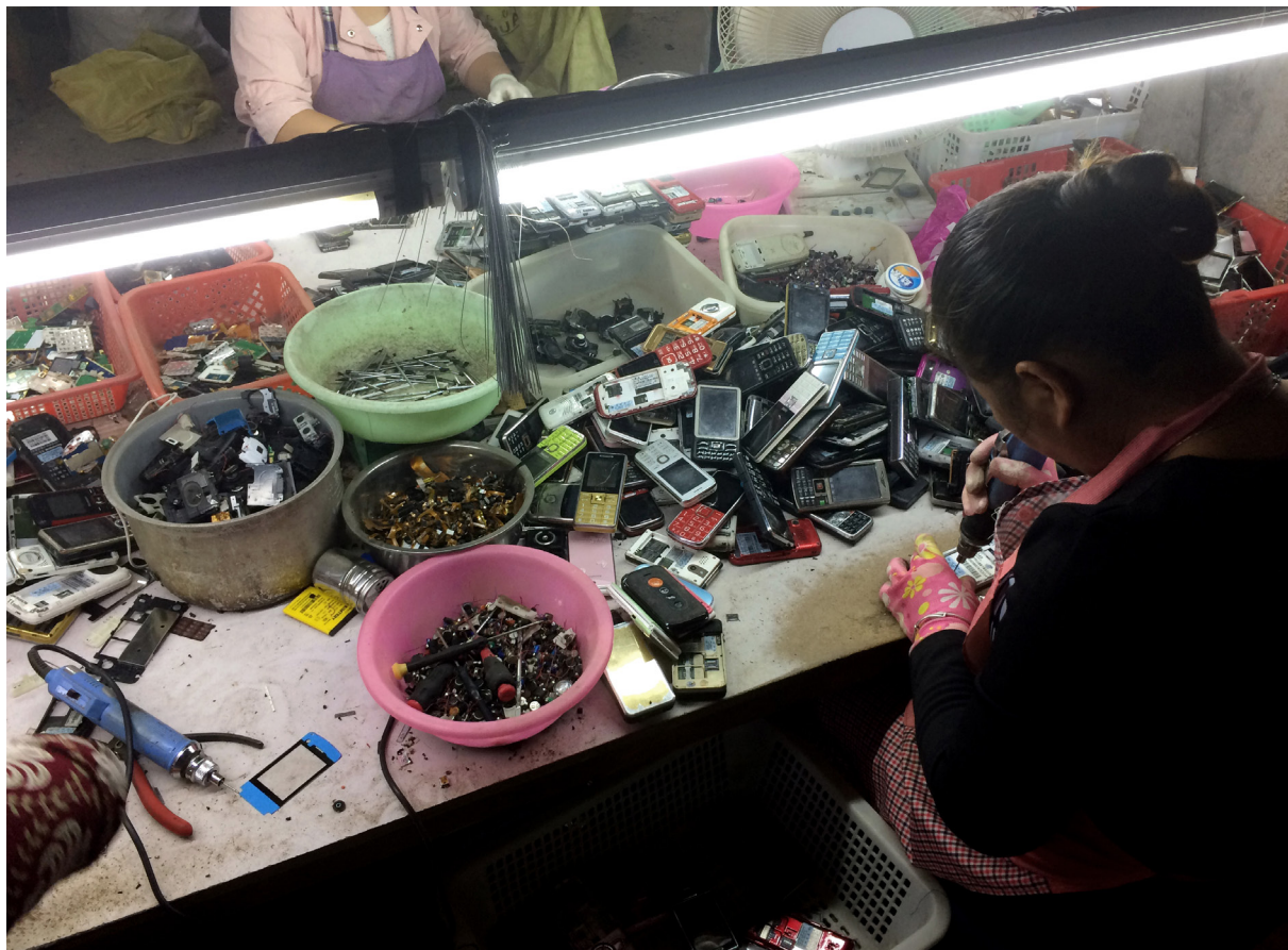
回收商对回收的手机进行拆解，分拣出屏幕、主板、摄像头等主要零配件。© Eric / Greenpeace
