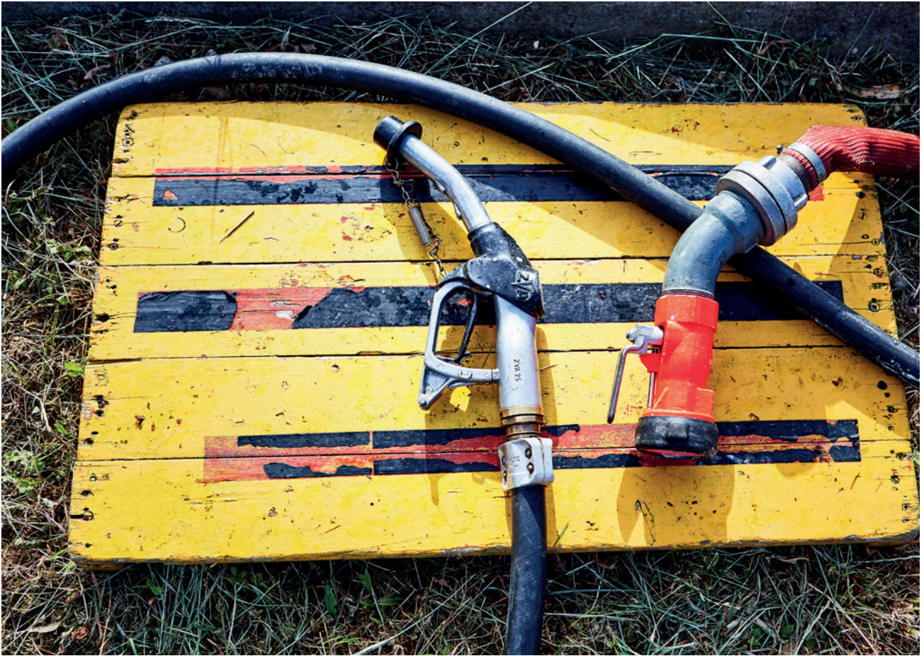
Einfüllstutzen für die Befüllung des Tanks mit den Fungiziden am Helikopter.
