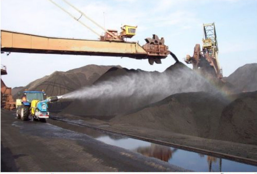
Şekil 152 Kömür Yığınlarının Mobil Spreyeme Aracıyla Nemlendirilmesine Örnek Fotoğraf
