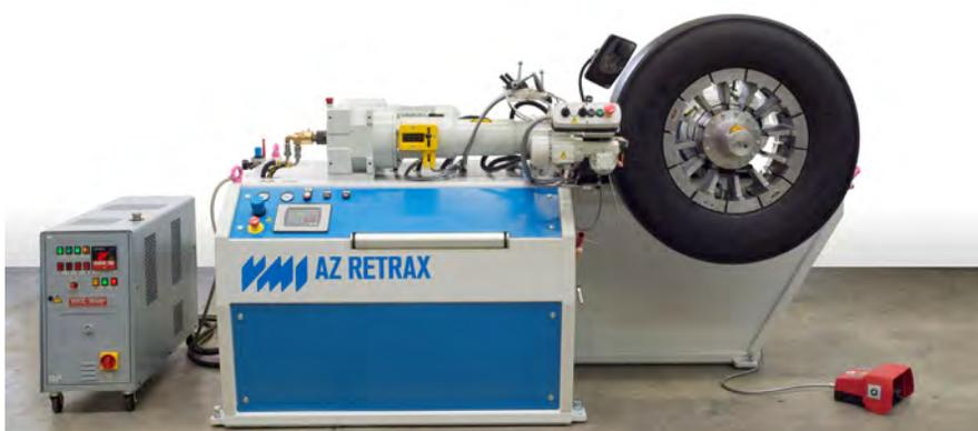
convenzionale ciascuno di questi crateri deve essere accuratamente riempito dall'operatore per rendere lineare la superficie, utilizzando un estrusore palmare. La tecnologia AZ Retrax riduce questo compito al minimo: solo i fori più profondi e con la forma più insolita necessitano di un trattamento speciale.
