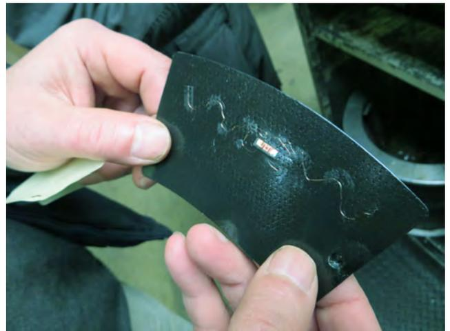
Il retro del sistema RFID di Roline rivela la dimensione del chip e l'antenna
