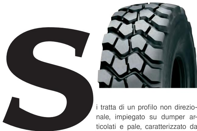
Si tratta di un profilo non direzionale, impiegato su dumper articolati e pale, caratterizzato da eccellente trazione ed elevata resistenza ai tagli e alle lacerazioni che possono verificarsi durante la lavorazione. Il battistrada "autopulente" è caratterizzato da una scultura profonda e massiccia che conferisce al profilo stabilità anche su terreni inconsistenti (fango) e resistenza in presenza di terreni sconnessi e aggressivi (pietre/rocce).
