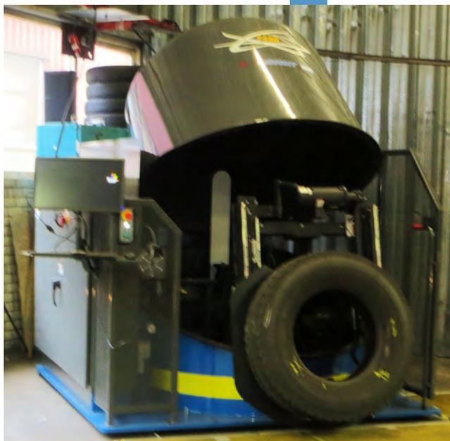
*Alla fine del 2014 Roline ha acquistato una nuova macchina per la scerografia, per identificare in modo efficace la separazione della zona del tallone*
