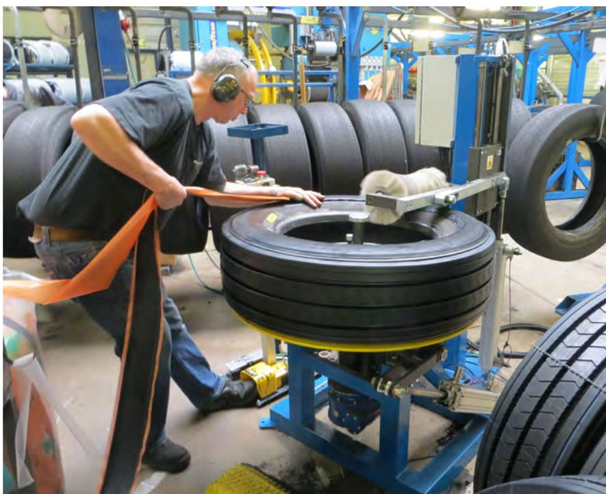
*Per ridurre al minimo i danni alla spalla del pneumatico, Roline appone uno strato di gomma aggiuntivo sulle gomme per bus che ricostruisce*
