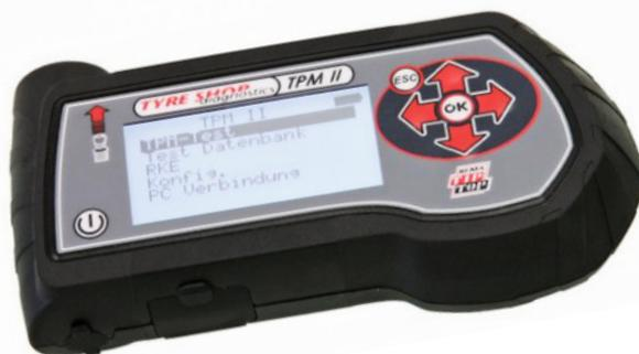
Lo strumento di diagnosi e programmazione di Rema Tip Top, il Profiler TPM II
