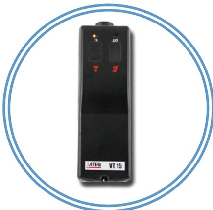
*ATEQVT: Il VT15 TPMS activator è lo strumento più semplice della gamma Ateq e si limita ad attivare i sensori*
