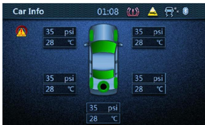
in Europa e 315 Mhz negli USA e in altri paesi. Questa è riportata anche direttamente sul sensore dove, anche se alcune volte è indicata con 434 Mhz, la frequenza è sempre la stessa. In ricezione, da centralina a sensore, la frequenza è invece di 125 Mhz. Ovviamente, dal momento che la centralina può identificare univocamente ogni sensore, e quindi il pneumatico ad esso associato, ad ogni sensore è assegnato un ID unico.
