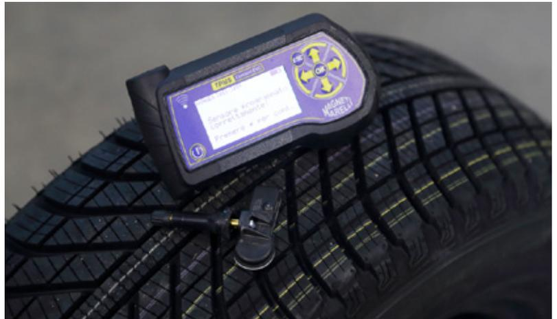
*TPMS Connect Evo di Magneti Marelli ha la possibilità effettuare la clonazione dei sensori, leggendo i dati dalla valvola OE, generandoli automaticamente o attraverso una procedura manuale. I Sensori Universali supportati sono: EZ-sensor (Schrader), Sens.it (Alligator), IntelliSens (Huf) e REDI-Sensor (VDO).*
