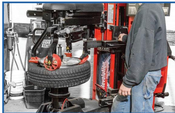
Il montaggio degli pneumatici sul cerchio è un'operazione più delicata di quello che sembra. Essa deve essere eseguita da uno specialista, che conosce le procedure di montaggio e dispone delle necessarie attrezzature.
