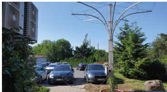
Konstrukce chytrého stromu ve verzi Singapur má širokou korunu s rozpětím pět metrů a lze na ni umístit například dobíjecí stanici pro elektromobily.
