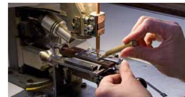
Výroba hlásků do harmonik zahrnuje různé formy strojařiny – obrábění, broušení i soustružení.
