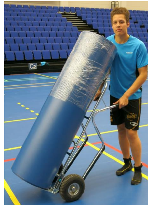
Kuva 22: Mattovuotarullien pakkaamisessa kannattaa käyttää pakkauskelmua ja sille tarkoitettua pakkaustyökalua, kuvassa esimerkkinä Telpak -käärintäkahva 450 mm.
