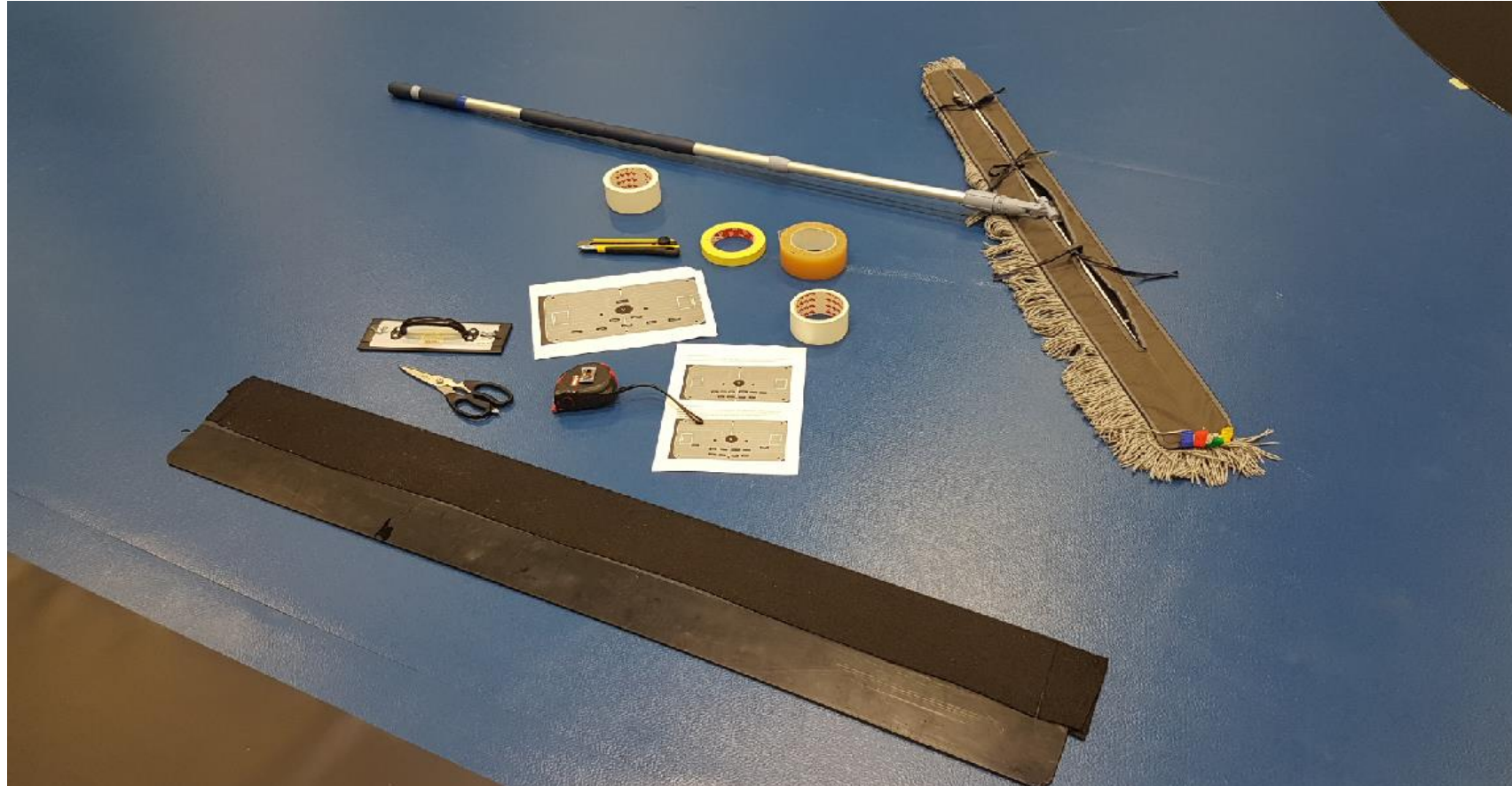
Kuva 55: Mattomainosten asentamisessa ja rajateippauksissa tarvittavia työkaluja ovat mattomainoskarta, asennuslastat, rullamitta, sakset, katkoteräveitsi, matonpuhdistusvälineet sekä teipit, ml. maalarinteippi.
