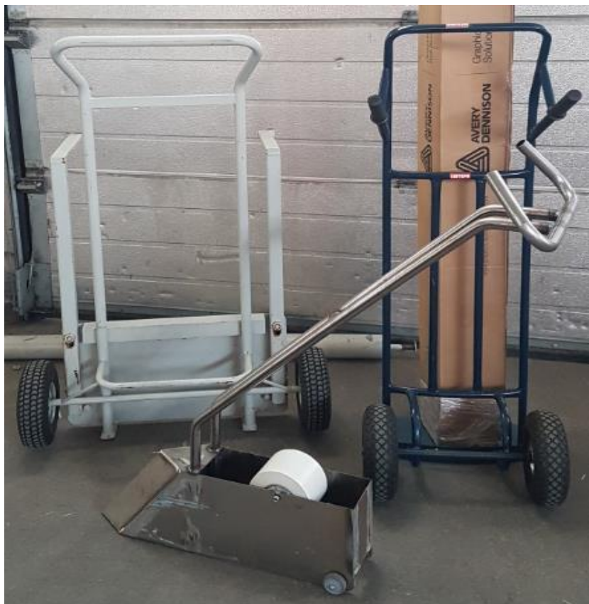
Kuva 19: Mattovuotien käsittely- ja asennustyökalut: maton levityslaite (harmaa), nokkakärri (sininen) ja saumateippauskone (rosteri)
