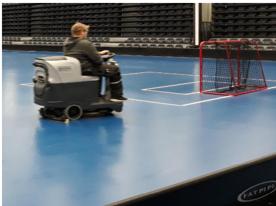
Kuva 40: Koneellisessa maton puhdistuksessa on varmistettava, että kone ei vaurioita maton pintaa tai saumoja ja ettei kone annostele liikaa vettä.
