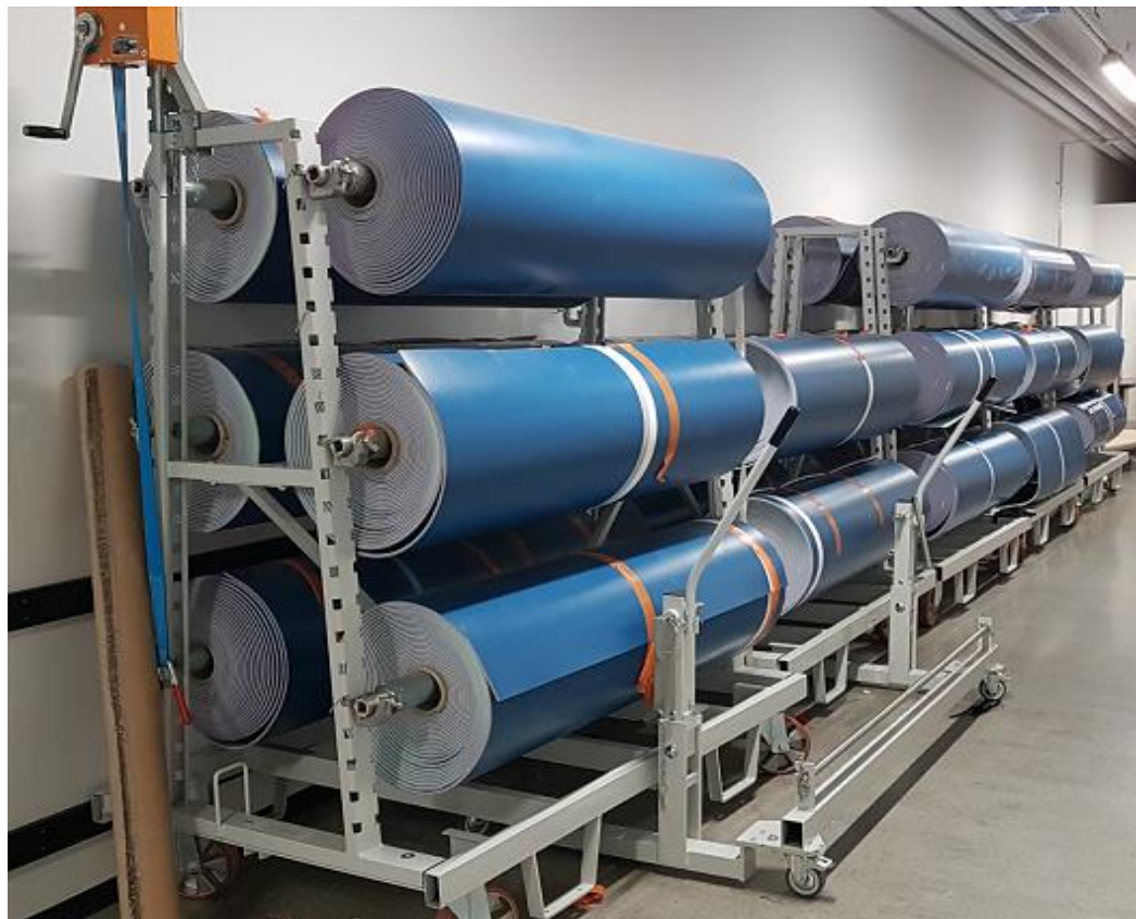
Kuva 50: Mattovuotarullien säilyttäminen ja varastointi tarkoitukseen kehitetyissä säilytystelineissä.
