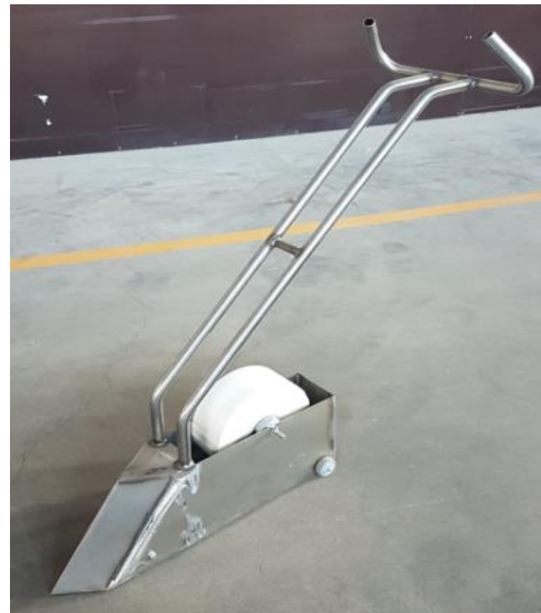
Kuva 29: Saumateippauskone. Saumateippi, 990m x 100mm, ei jätä liimajäänteitä eikä jälkiä mattoon). Kolme rullaa riittää viiteen asennukseen.
