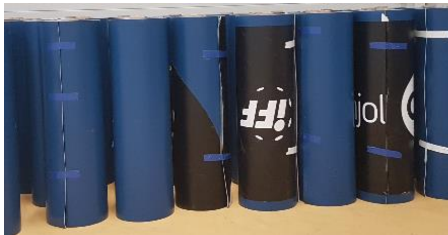
Kuva 49: EI NÄIN - Teippiä käytetään riittävä määrä ja riittävän moneen kohtaan mattorullaa niin, että mattorulla ei lähde esim. kuljetuksessa aukeamaan.
