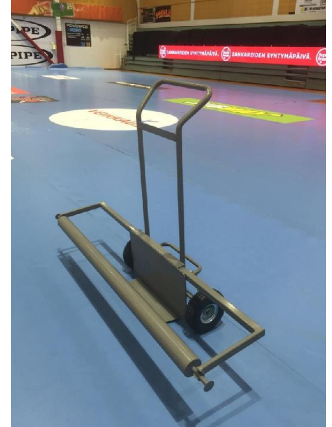
Kuva 53: Siirtomaton asennuksessa tarvittavia työvälineitä ovat maton levityslaite, teippauskone ja nokkakärky(t)
