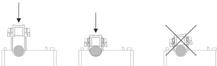
Führen sie die Anschlussleitung gerade durch die Zugentlastung.
