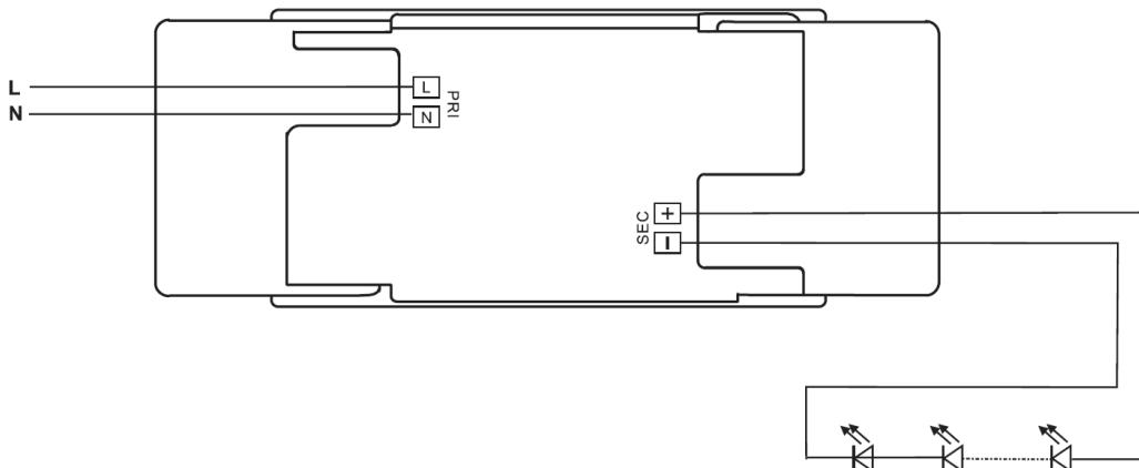
Die maximale Länge der Ausgangsleitung von 2 m darf nicht überschritten werden.
