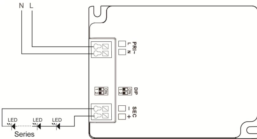
Stromeinstellung – Current adjustment – Réglage du courant – Ajuste de la corriente – Stroominstelling
