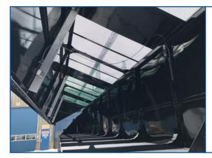
LASHING CABLE INTEGRATED IN THE DOOR CLOSING SYSTEM
