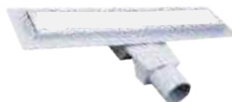
Φρεάτιο δαπέδου έξοδος Φ50, συμβατό με κεραμικά, 360° περιστροφή
