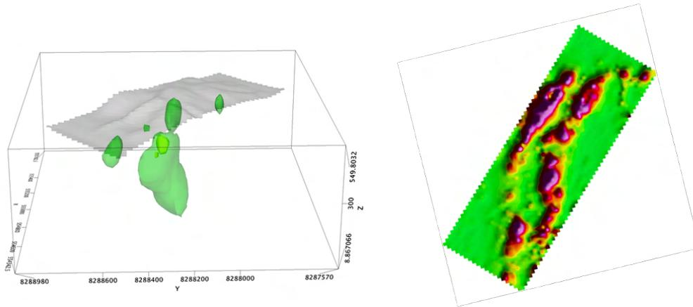
No mapa é possível identificar as dobras, cujas feições tem associação aos magnetitos e depósitos de BIF's. À esquerda está o **modelo 3D** suavizado de área adjacente, representando a fonte dos depósitos de Fe com o **Modelo Digital de Elevação (MDE)** à direita.
