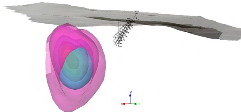
A magnetometria foi utilizada para **reprojetar as sondagens e modelar o corpo de minério**. O objetivo foi concluído com **sucesso** e as duas sondas interceptaram o centro do depósito.
