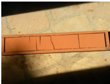
RETRAÇÃO APÓS 7 DIAS = 2.4 mm (ensaio de caixa)
