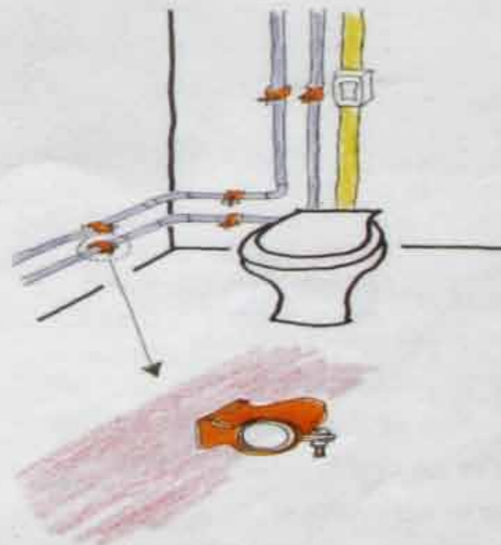
Instalações hidráulicas aparentes
