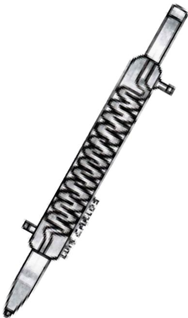
Vidraria utilizada para condensação de vapores, em processos de destilações ou aquecimentos que necessitem do sistema de refluxo.
