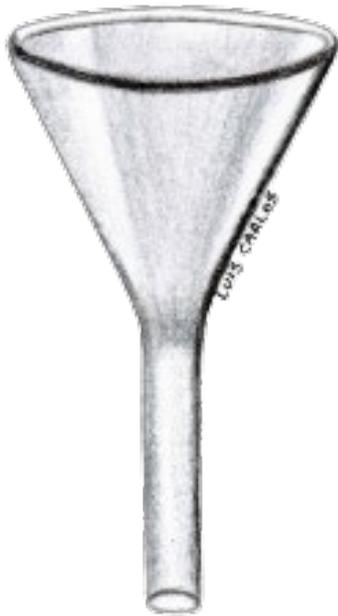
Vidraria utilizada na transferência de líquidos de um frasco para outro ou para filtrações simples.
