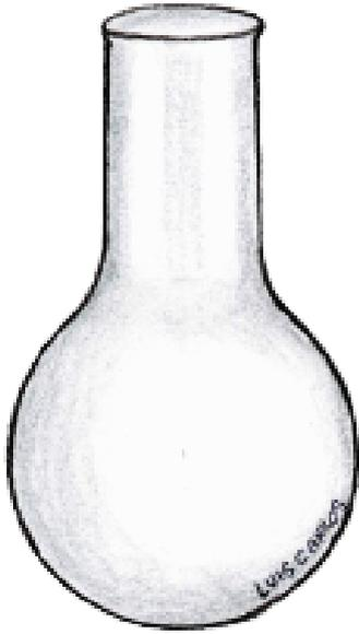
Frasco utilizado para armazenar soluções ou aquecimento de misturas em manta térmica.
