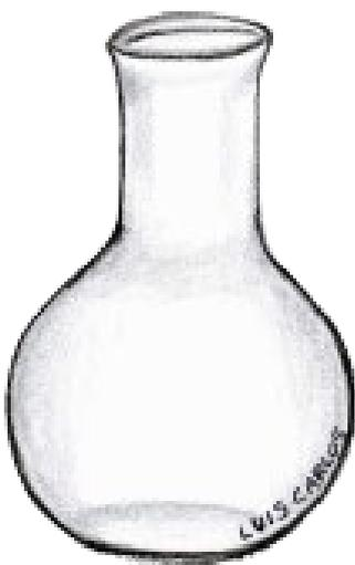
Frasco utilizado para armazenar soluções ou para aquecimento de misturas em chapa de aquecimento.
