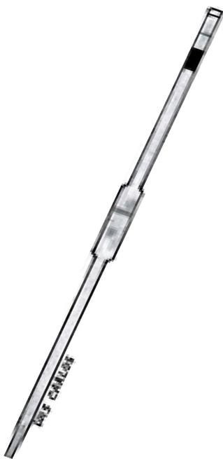
Vidraria volumétrica com precisão, utilizada para o escoamento de volumes fixos de líquidos.
