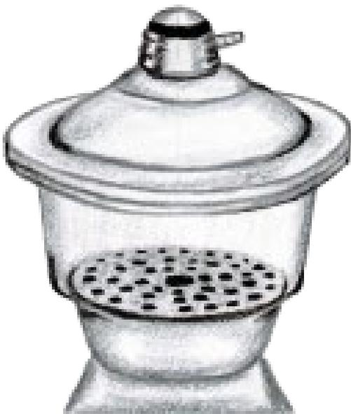
Utilizado para armazenar substâncias que necessitem de uma atmosfera com baixa umidade. Possui uma saída para conexão com uma bomba à vácuo, para retirada da umidade interna.
