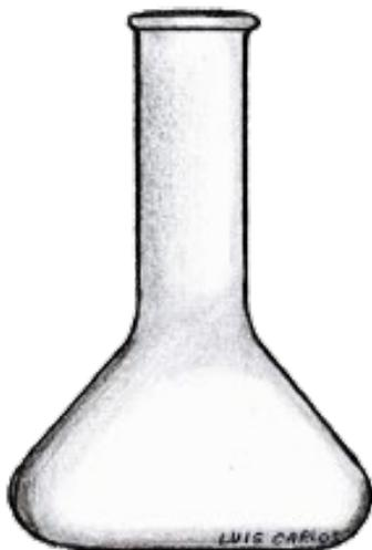
Recipiente de precisão, destinado a conter um determinado volume de líquido, a uma determinada temperatura. Utilizado também no preparo de soluções com concentrações definidas.
