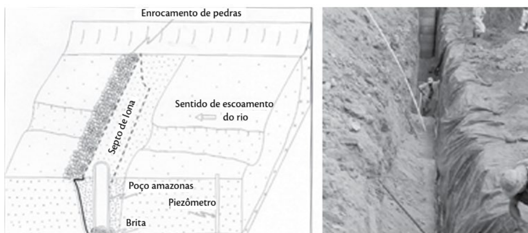
Figura 7: Desenho esquemático e detalhe da construção de uma barragem subterrânea no Modelo Costa e Melo.
