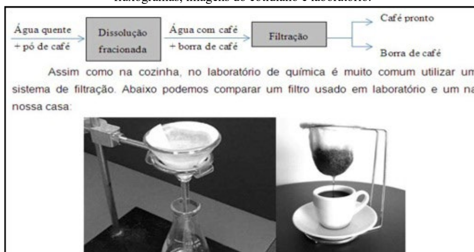
Figura 1 – Recortes da nota de aula elaborada. Processos de separação envolvidos na preparação do café: fluxogramas, imagens do cotidiano e laboratório.
