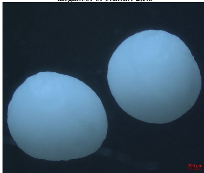
Figura 3: Micropartículas de óleo de pequi em matriz polimérica de alginato e quitosana. Microscopia óptica, magnitude de aumento 2,5x.
