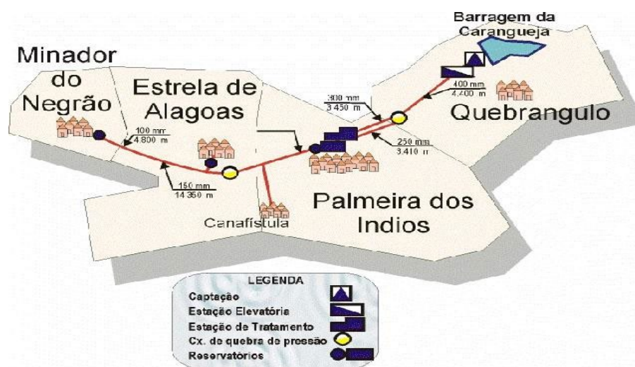
Figura 6 - Adutora da carangueja
