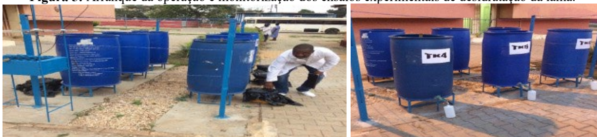
Figura 5: Arranque da operação e monitorização dos ensaios experimentais de desidratação da lama.
