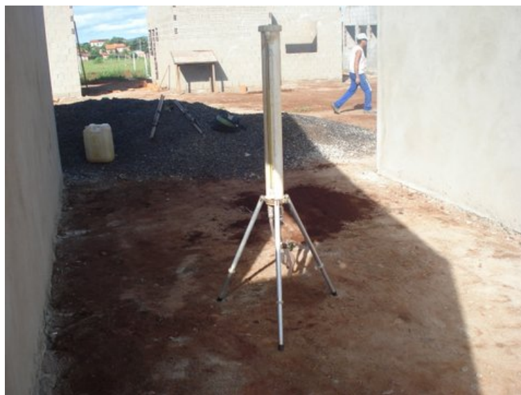
Fig. 05 – Em primeiro plano verifica-se o aparelho de Guelph para medição da água no solo (teste de percolação) e ao fundo o Latossolo Roxo (F. D. Oliveira, 01/2012).
