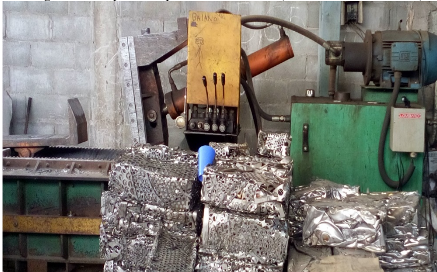
Imagem 4 – Máquina compactadora de sucatas (Motor 30 Cv de Potência)
