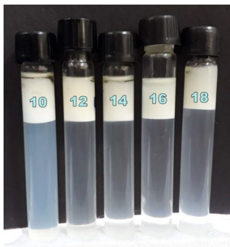
Figura 3: Emulsões obtidas a partir do óleo de soja, com seus respectivos valores de EHL
