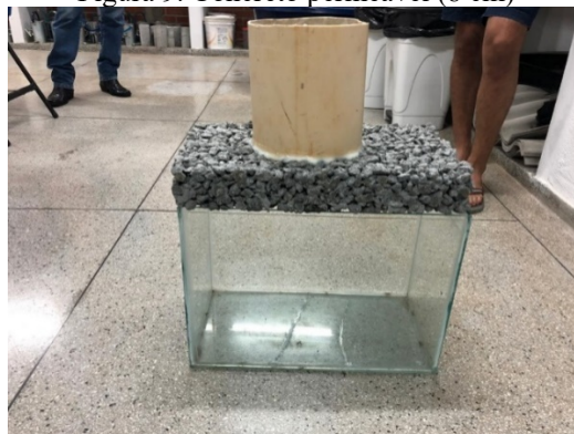
Figura 9. Concreto permeável (8 cm)
