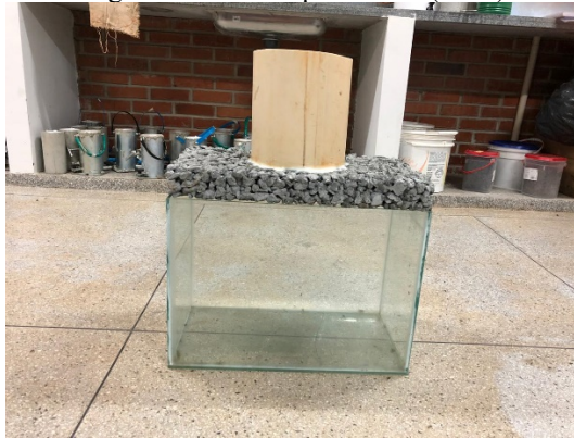
Figura 8. Concreto permeável (6 cm)
