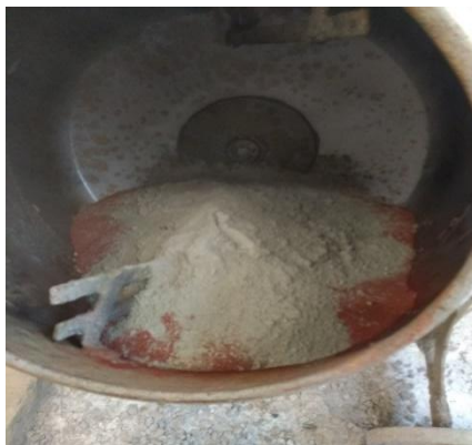
Figura 3 - Homogeneização dos Materiais Secos
