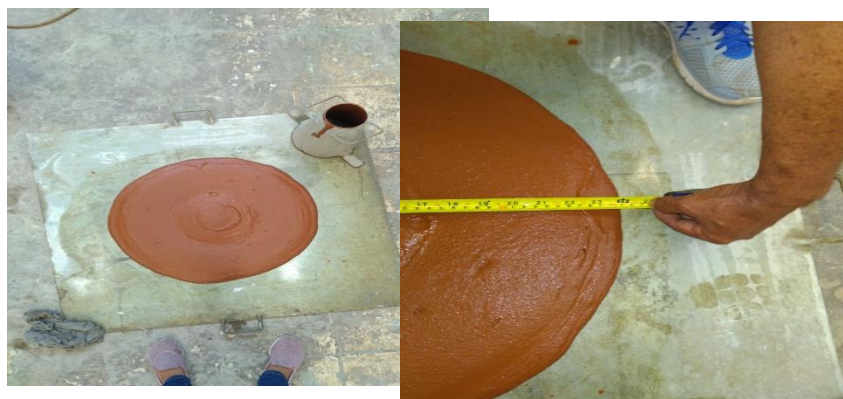
Figura 4. Teste de espalhamento.
