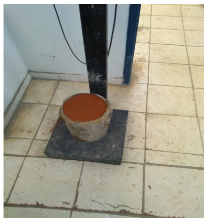
Figura 8. Densidade da Massa Fresca
