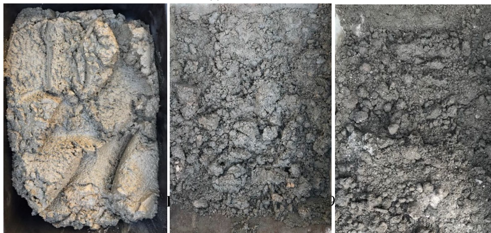
Figura 03 – Consistência das argamassas após a adição da mesma quantidade de água: (a) argamassa com areia comum; (b) argamassa com 50% areia comum e 50% areia reciclada; (c) argamassa com 100% de areia reciclada.
