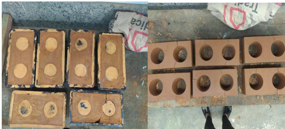
Figura 11- Fissura nos blocos solo-cimento antes e depois do desmolde
