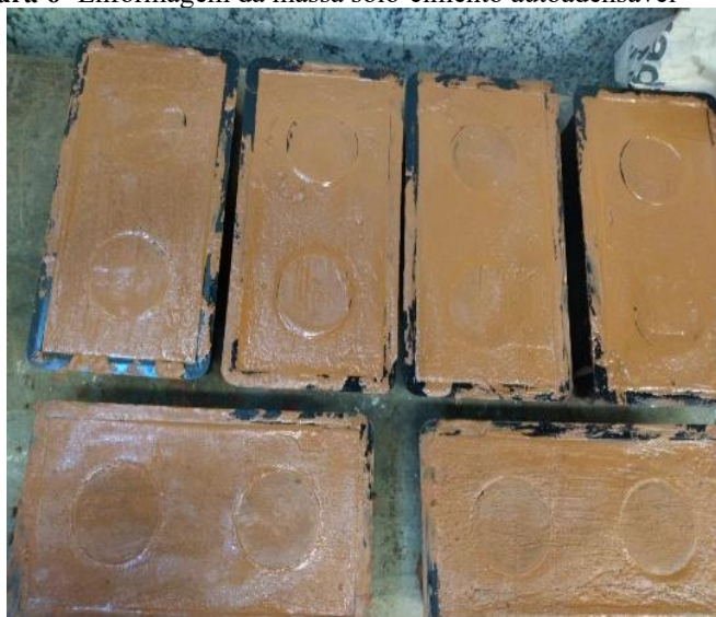
Figura 6- Enformagem da massa solo-cimento autoadensável
