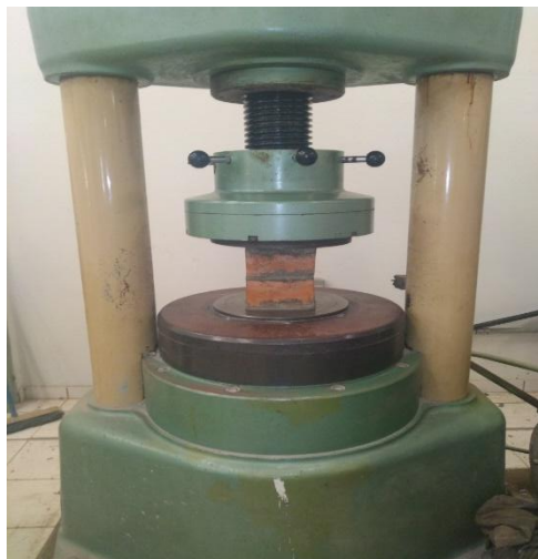
Figura 9. Corpo de prova sujeito ao ensaio de compressão uniaxial
