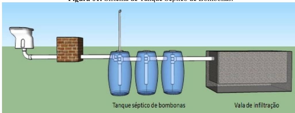
Figura 01: Sistema de Tanque Séptico de Bombonas.
