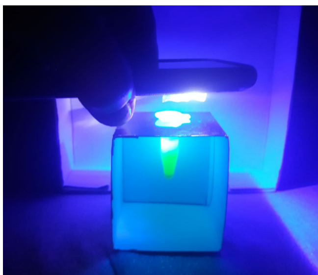
Figura 2: Solução contendo corante obtido de caneta marca texto submetido à radiação ultravioleta usando a lanterna de um smartphone .
