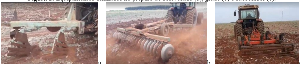
Figura 2: Equipamentos utilizados no preparo do solo: arado (a), grade (b) e subsolador (c).
