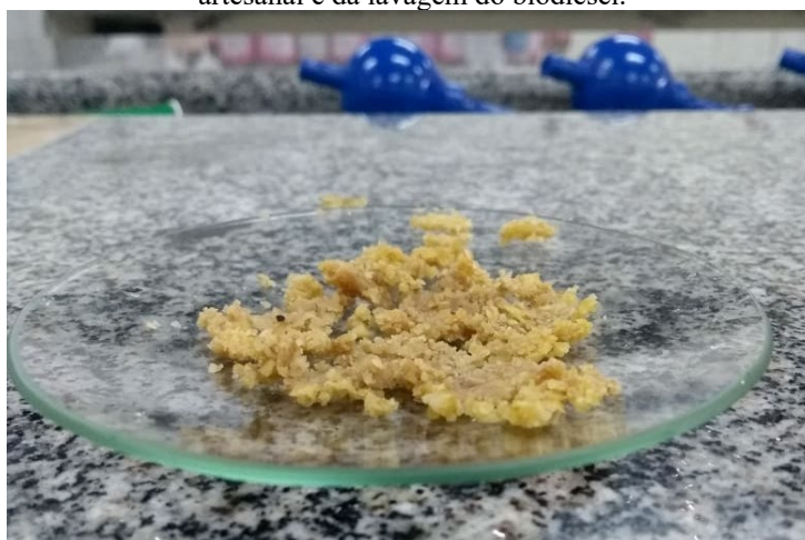
Figura 3: Amostra obtida após o processo de coagulação do resíduo da lavagem dos tanques da cervejaria artesanal e da lavagem do biodiesel.
