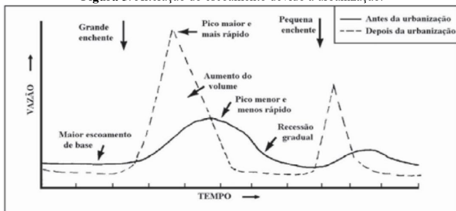
Figura 5: Alteração do escoamento devido a urbanização.
