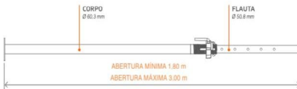
Figura 7: Detalhe Escora Metálica.
