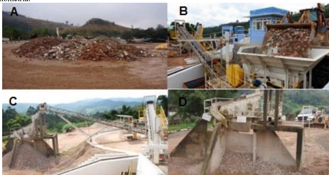
Figura 6. Etapas de uma usina de reciclagem de entulhos. A – depósito de resíduos para triagem; B – equipamento de moagem; C – britador de mandíbula e D – agregados já reciclados classificados de acordo com sua granulometria.
