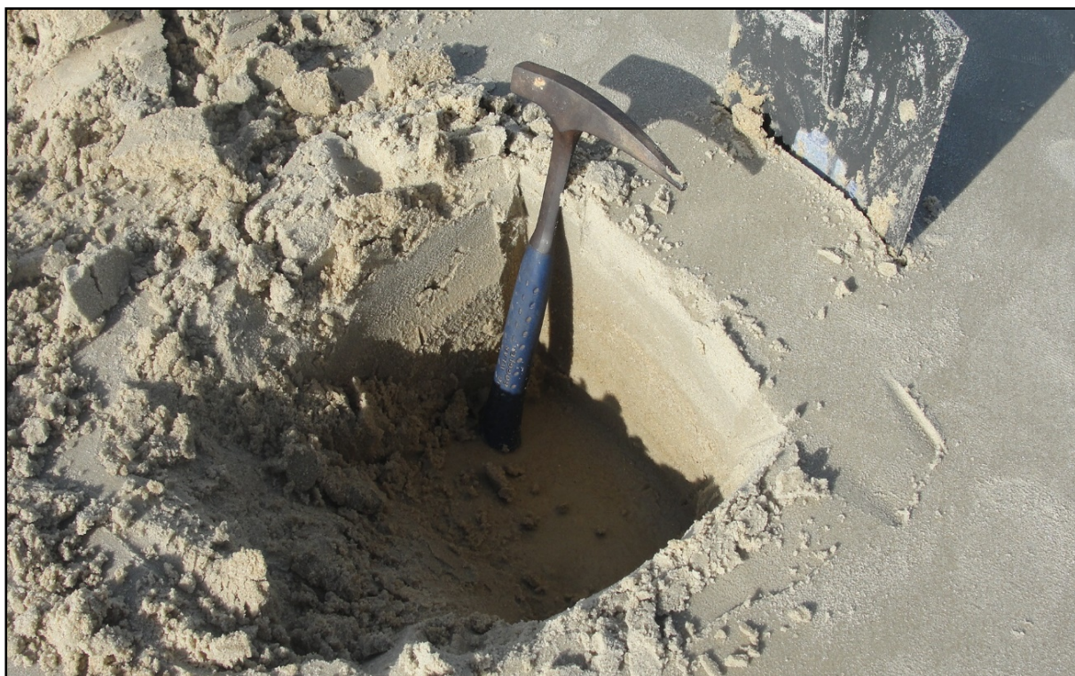
Foto 6. Amostra 53/100: sedimento siliciclástico, estratificado, quartzoso, da praia da Joaquina Norte, na costa Sudeste, mostrando areia fina ( 2,29 \phi ) e moderadamente bem selecionada ( 0,64 \phi ) nas coordenadas (UTM x 6941147.26 e UTM y 751620.37) (Foto de Norberto Olmiro Horn Filho, dezembro de 2007).
