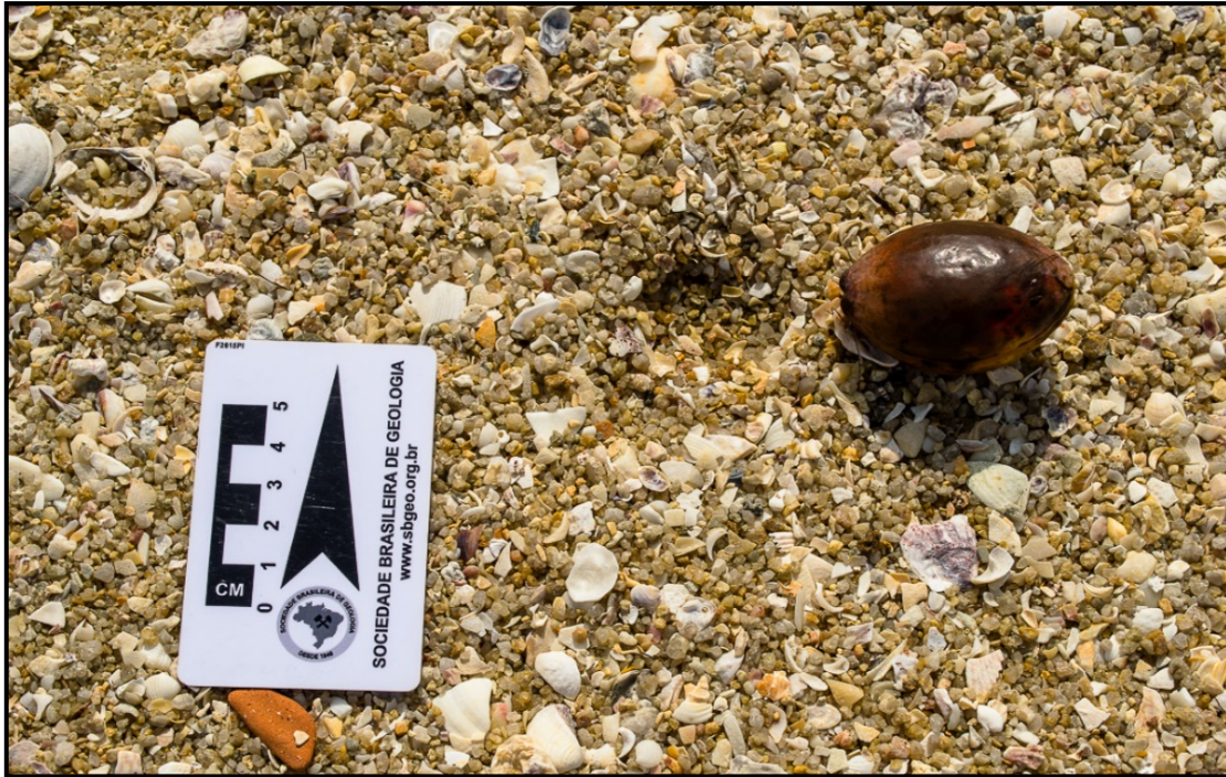
Foto 3. Amostra 72/100: sedimento bioclástico, maciço, carbonático, da praia de Fora Sul, na costa Sudoeste, mostrando areia muito grossa (-1,68 \phi ) e pobremente selecionada (1,46 \phi ) nas coordenadas (UTM x , 6926425.88 e UTM y , 738928.08). Observa-se ainda sobrecarga formada por fruto em grânulos no pós-praia. (Foto de João Pedro Canhisares, abril de 2019).
