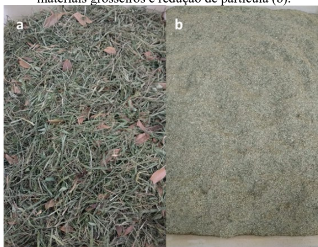
Figura 1: Amostra de resíduos de grama coletada na área verde da instituição (a) e amostra após a separação dos materiais grosseiros e redução de partícula (b).
