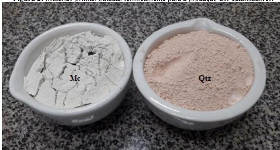
Figura 2: Matérias-primas tratadas termicamente para a produção dos catalisadores.
