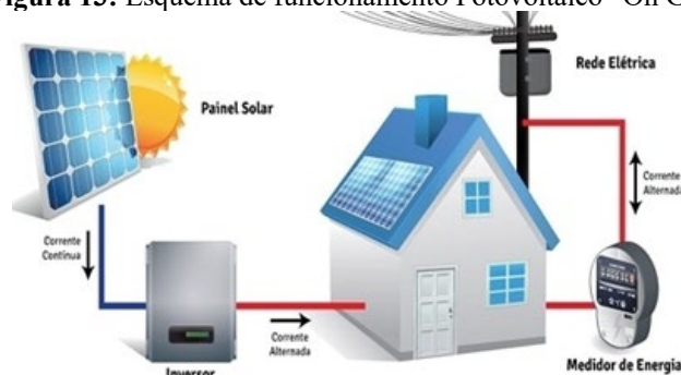
Figura 13: Esquema de funcionamento Fotovoltaico “On Grid”.
