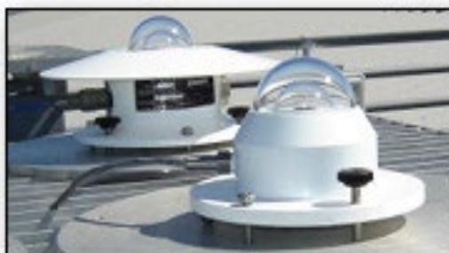
Figura 5: Piranômetro modelo Eppley GPP - equipamento usado para medir radiação solar.
