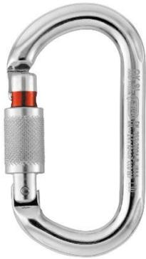
formato oval com curva simétrica dos dois lados, indicado para ser utilizado com roldanas e outros equipamentos como freios, trava quedas etc. que requerem uma ligação estável e uniforme, para não sofrer forças extremas em um só ponto. Não deve sofrer cargas dinâmicas ou seja quedas com trancos. Também muito usado para carregar peças de escaladas moveis pois ficam mais estáveis penduradas em um mosquetão oval.
