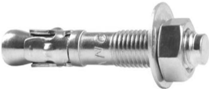
O outro chumbador expansivo é do tipo PBA basicamente o que tem de bom é que utiliza o furo com o mesmo diâmetro do parafuso ao contrário do CBA que possui a jaqueta maior, se você quer utilizar o parafuso M12 terá que furar com diâmetro de 14 mm, o que tem de ruim é a instalação, pois as vezes são mais difíceis para travar e começar a dar aperto, falando em resistência e certificação os dois são bem parecidos.
