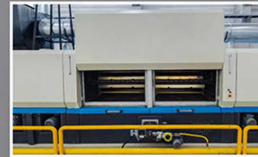
Lift tipi pnömatik kontrollü kabin kapakları. Lift type pneumatic controlled cabin doors.
