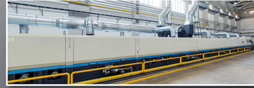
Komple baca borulaması, Baca yangın tertibatı. Complete exhaust ducting, Exhaust fire extinguishing system.
