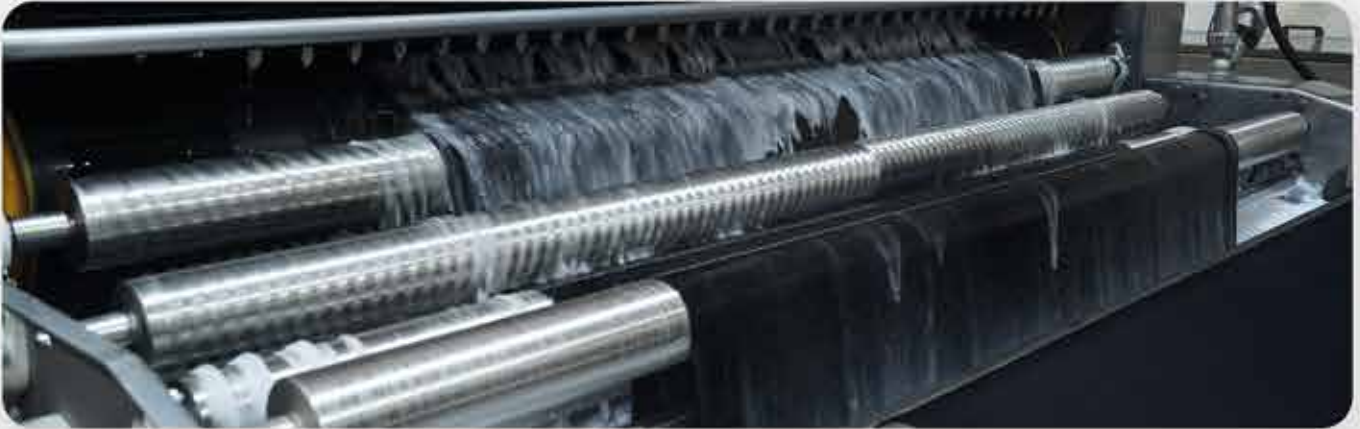
Enzim Yıkama Ünitesi / Enzym Wash Unit
