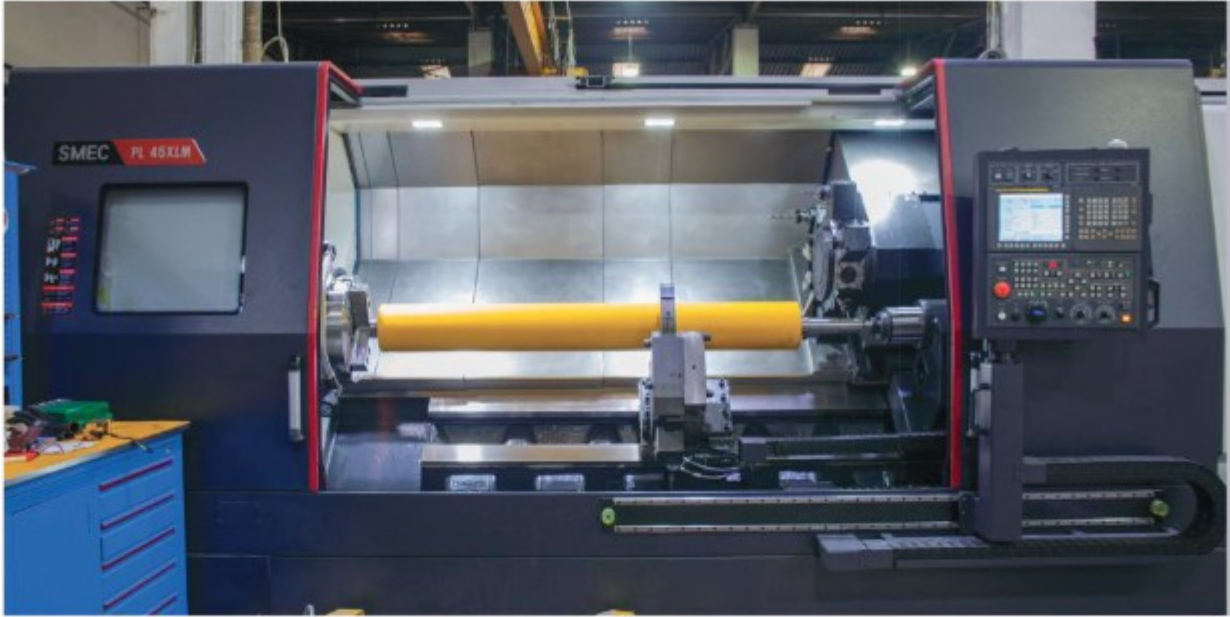
Modern işleme tezgahlarında silindir imalatı Production of roller on modern machining machines
