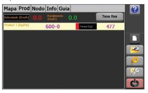
→ Independentemente da alteração da velocidade de trabalho, o Fertil Taxa Fixa garante a Dose aplicada corrigindo automaticamente a vazão de insumo.
