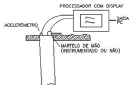
Figura 1 – Ensaio PIT. (a) Execução no campo; (b) Representação esquemática (adaptado de Rausche et al. , 1992)
