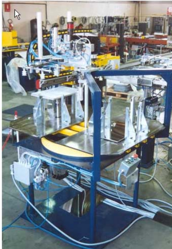
Magazines e desempilhadores para alimentação de peças
