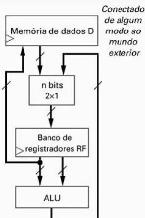
Figura 8.2 Bloco operacional básico de um processador programável.
