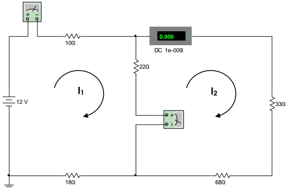
3. Montar as equações de malha e encontrar os valores teóricos das correntes  $I_1$  e  $I_2$  e tensões.
