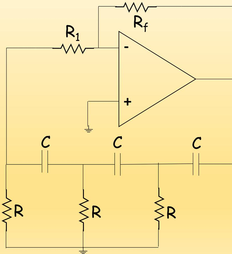
Para que o valor de  $R_1$  não influencie na malha RC uma vez que se encontra em paralelo com o resistor  $R$  ( $R_1$  ligado em ponto de terra virtual), deve-se fazer  $R_1 \gg R$ , tal que  $R_1 // R \cong R$ .
